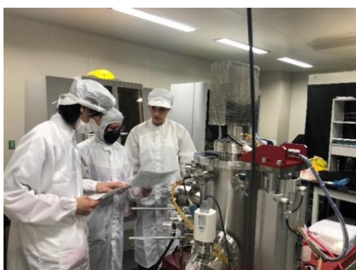
図3：クリーンルーム内で太陽電池を作成している様子
